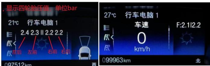
**优点：**翼虎自带胎压传感器，仅需一个 OBD 即可实现，成本不高，仪表集成，显示效果尚可，有种原厂的效果，无需外置显示器，车内清爽；
